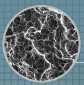
SLA: SAND BLASTED & ACID ETCHED
